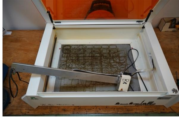
**Vorsicht:** Bevor das Bauteil entnommen werden kann, müssen die Verbindungen durch das Flachkabel sowie den Luftschlauch des Kompressors gelöst werden.
