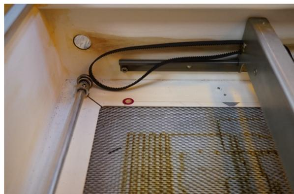
Als nächstes muss die Endanschlagsschraube (H3) aus der Fahrschiene herausgeschraubt werden. Im Anschluss kann das Querprofil mit dem Laserkopf vorsichtig von der Schiene gezogen werden.
